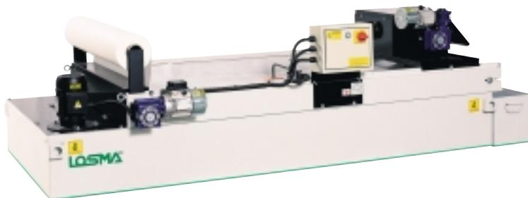
La serie DECOM utilizza entrambi i sistemi in combinazione (tessuto filtrante + dischi magnetici rotanti), è in grado di depurare da 50 a 400 litri/minuto di olio emulsionato e da 25 a 200 litri/minuto di olio intero, contaminati sia da particelle magnetiche che amagnetiche.
